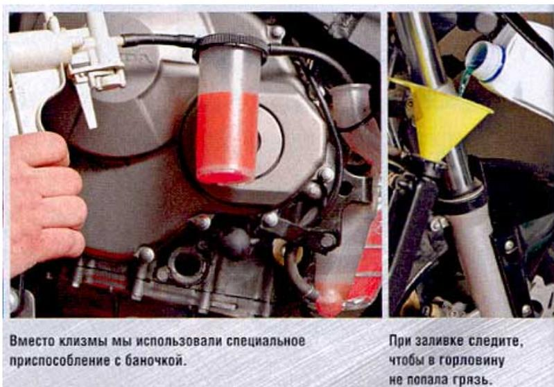
Каждые два года необходимо менять охлаждающую жидкость в мотоцикле. В противном случае начнут быстро корродировать внутренности двигателя, портиться помпа и подклиниваться клапан термостата. Плохая работа системы охлаждения может привести к перегреву. В том случае, когда сальник помпы, замерзший из-за отсутствия смазки, начнет антифриз пропускать в картер, тогда через несколько километров езды с такой неисправностью начнет стучать двигатель.
